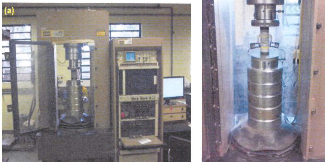
Fig. 20- (a) Prensa e painel de controle da prensa (b) Corpo de prova com extensômetro.
