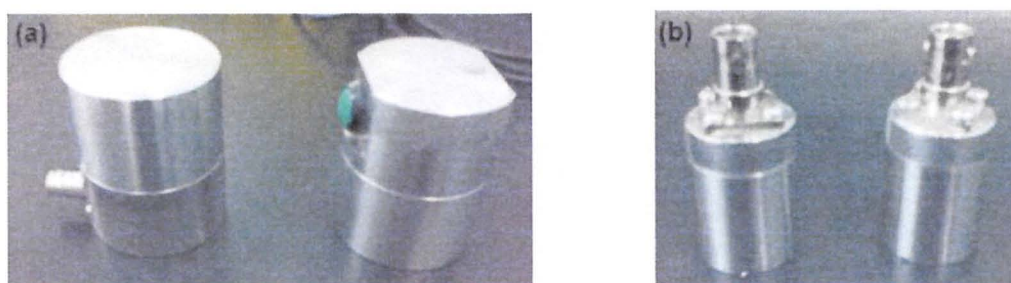
Fig. 12- (a) Transdutor de 54 kHz, com 5cm de diâmetro. (b) Transdutor de 150 kHz, com 2,2cm de diâmetro.
