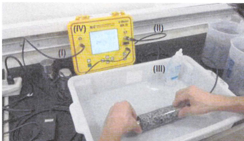
Fig. 13- (I) Fio ligado no terminal transmissor. (II) Fio ligado no terminal receptor. (III) Gel de ultrassom. (IV) Aparelho de ultrassom V - Meter III da James Instruments Inc.
