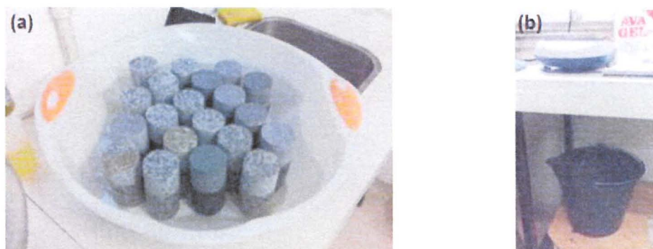
Fig. 11- (a) Corpos de prova submersos, até 2/3 do comprimento, em água destilada. (b) Balde cheio de água com cesto ligado à balança por um fio.
